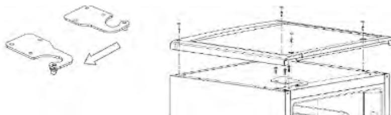
Наденьте снятую в пункте 1 крышку, затяните винты и наденьте колпачки.
